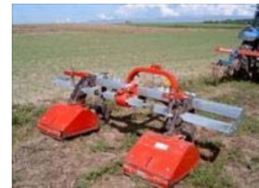
Mekanisk ukrudtsbearbejdning ved hjælp af en rækkefræser.
